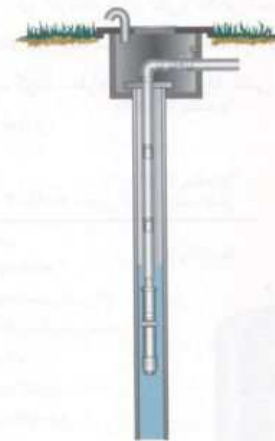
شکل ۶-۱۱-۲ تنوره چاه یا پمپ شناور
