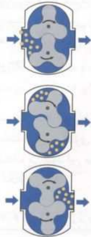
شکل ۶-۷-۱۳ اصول کار پمپ های دندانه ای
