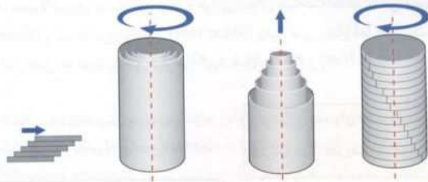
شکل ۳-۲ صورتهای مختلف نیروی های برشی
