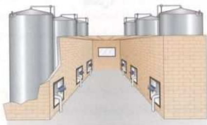
شکل ۶-۹-۲ مخزن سیلو با دریچه آدم رو، موتور و هم زن
