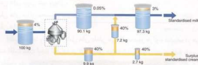
شکل ۳۲-۲-۶ اصول استاندارد کردن چربی
