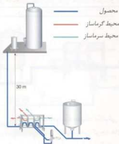
شکل ۷-۹ خط فراوری نشان دهنده مقاومت در برابر جریان با ارتفاع (هد) ۳۰ متر
