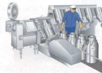
شکل ۵-۹ محل دریافت شیر در داخل بیدون بر اساس سیستم وزن سنجی
