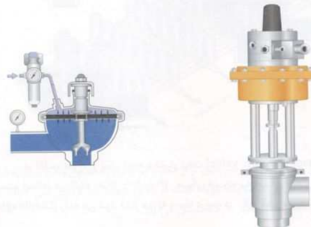
شکل ۶-۸-۱۹ دریچه کنترل پنوماتیکی با توپی تغییر دهنده جریان
