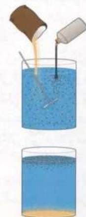
شکل ۳-۲-۶ رفتار شن و روغن پس از اختلاط در آب
