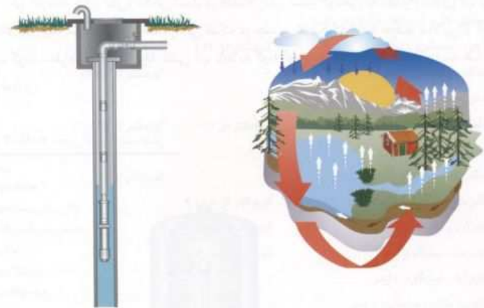
شکل ۶-۱۱-۲ تنوره چاه یا پمپ شناور
