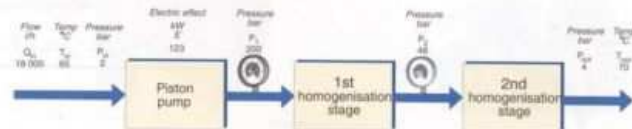
شکل ۹-۳-۶ انرژی، دما و فشار در یک نمونه هموژنیزاسیون
