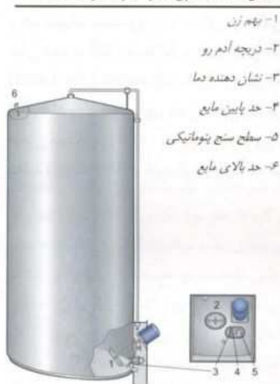
شکل ۱۵- مخزن ذخیره شیر با اجزاء ضمیمه
