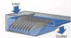
شکل ۶-۲-۱۰ ظرف رسوبی با طبقات خنثی مایل که با ایجاد جریان لایه ای باعث ریزش ذرات در ته ظرف می‌گردد.
